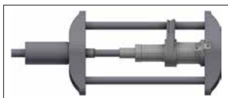
Einbausituation einer geschlitzten und gespannten Buchse
