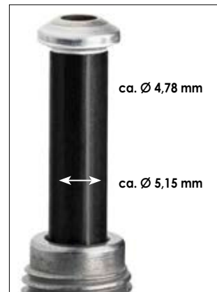
Positionierung der Leitung um Ummantelung abzuschaben
